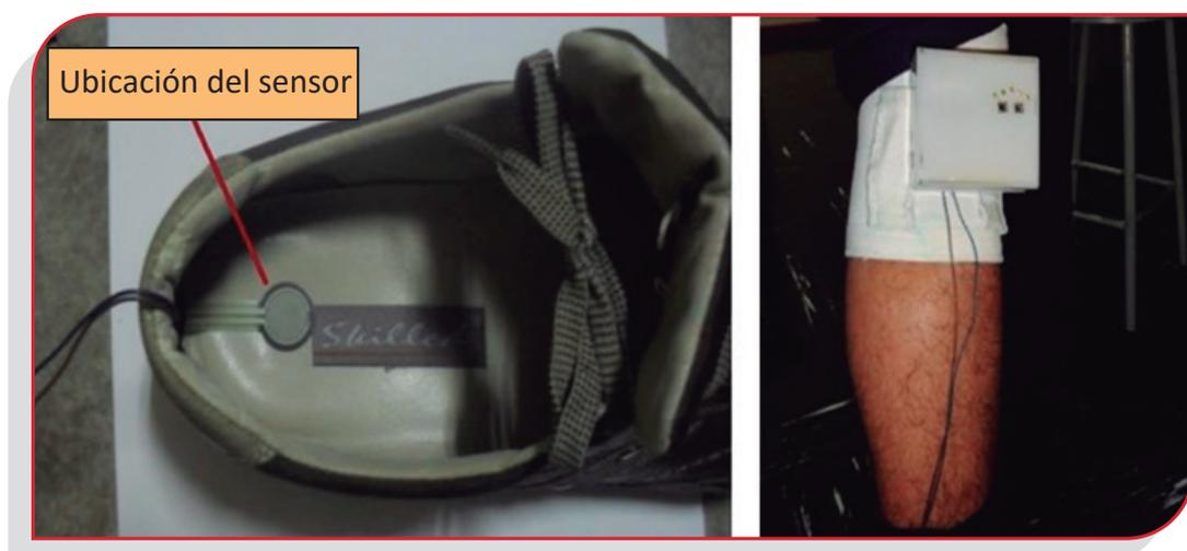
Fig. 1.30. Izq.: Sensor en planta. Der.: Sistema en tobillo (Calderón, 2019, pp. 56 y 68)
