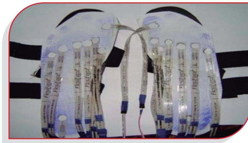
Fig. 1.33. Sensores adheridos a la plantilla (Cucho y Alarcón, 2012, p. 37)
