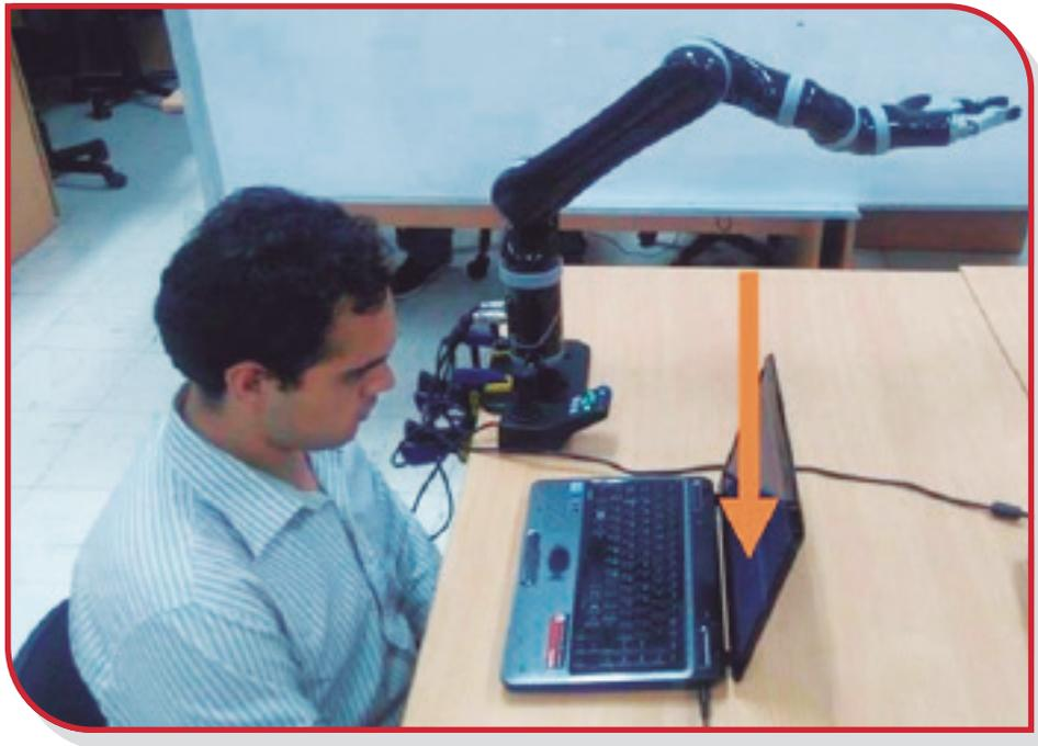
Fig. 1.5. Control del brazo mediante movimientos de la cabeza (Angulo, 2016, p. 44)
